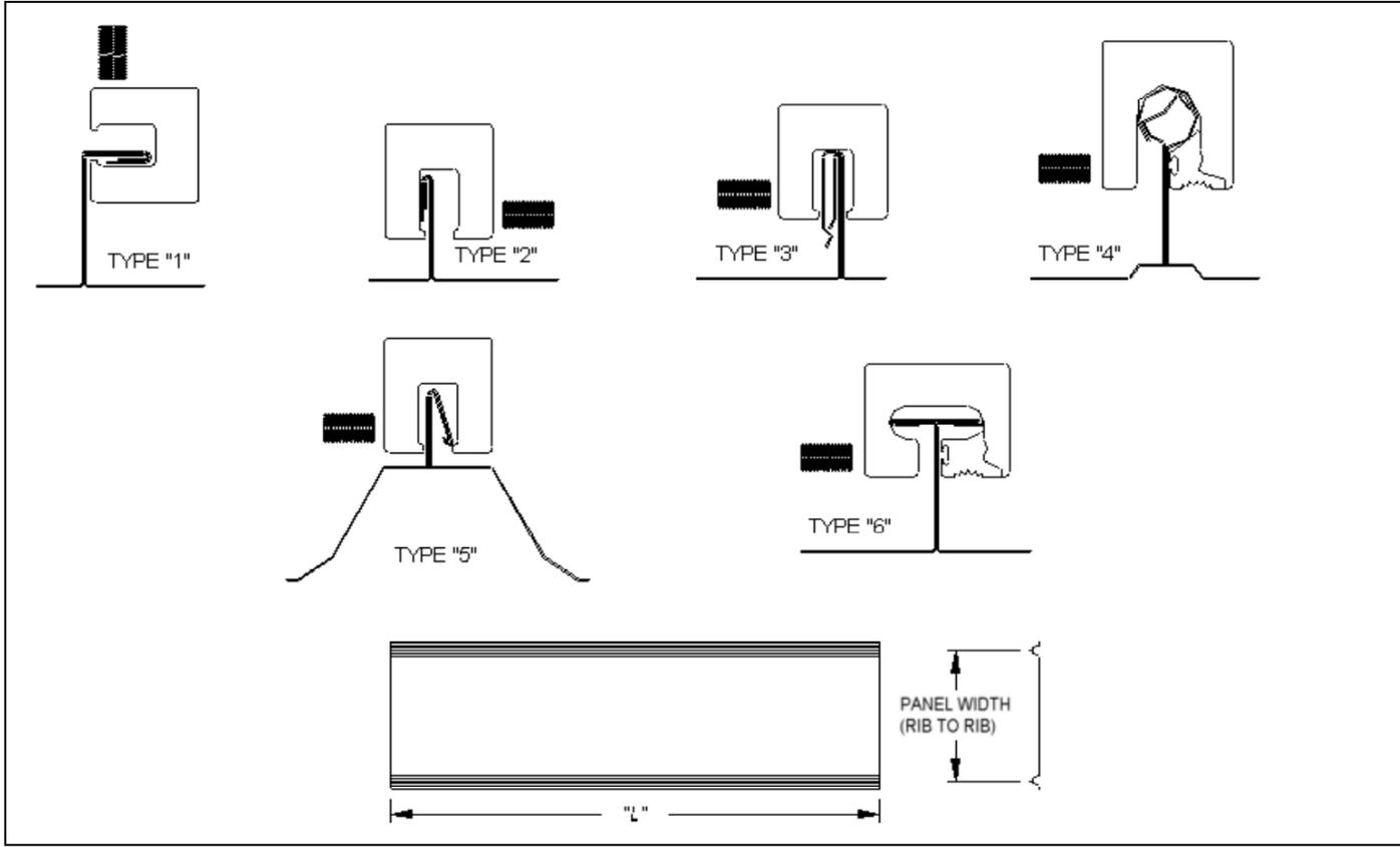
Nota: Las mediciones de ancho se deben hacer de cresta a cresta sobre el panel del techo metálico. La medida del largo es la longitud del panel del domo. Se requerirán fotografías de las unidades existentes para aplicaciones personalizadas.
